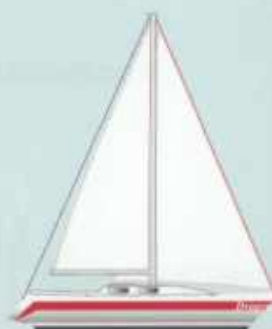
Дробное вооружение Фор-штаг закреплен на некотором расстоянии от топа мачты
