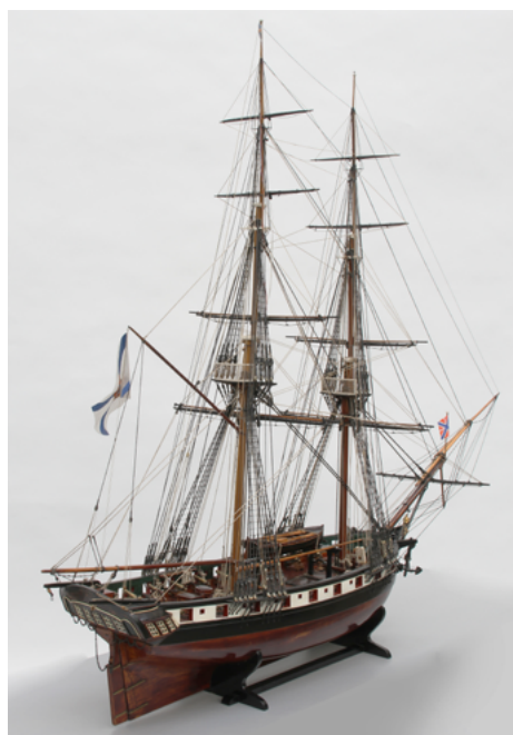
Модель с рангоутом 20-пушечного брига «Меркурий» построенного в 1820 г. (ЦВММ)
